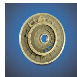
Produit moulé intermédiaire - A357 960 x 960 x 310 mm - 79 kg
