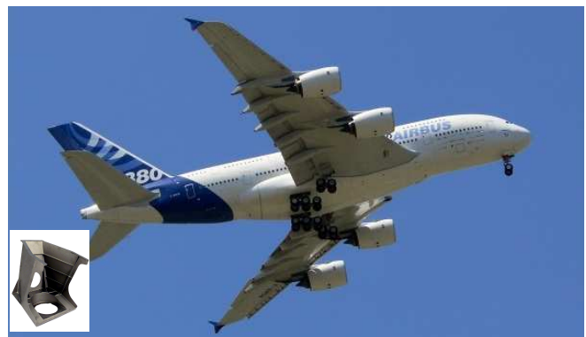
A 380 mit Titanbauteilen für die Triebwerksaufhängung.
